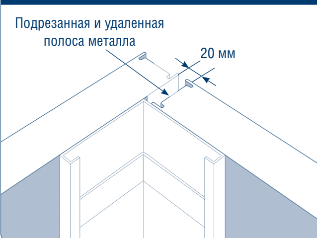
Рис. 7.5.11. Узел 1. Внешний угол
